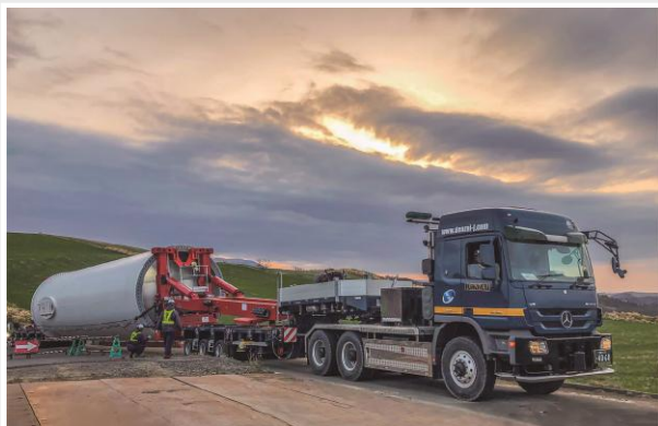
プライムムーバー（風車タワー輸送）
